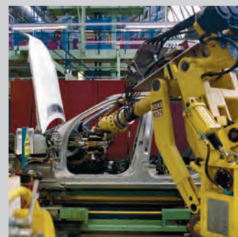
汽车行业的车身电动悬挂轨道 通过测距传感器进行车身定位
