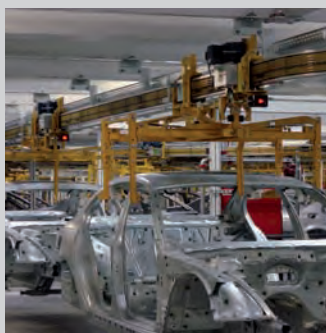
汽车行业的车身电动悬挂轨道 通过测距传感器进行车身定位
