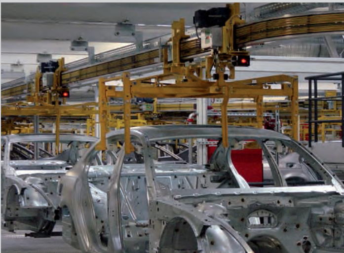
汽车工业中的高架台车输送系统
