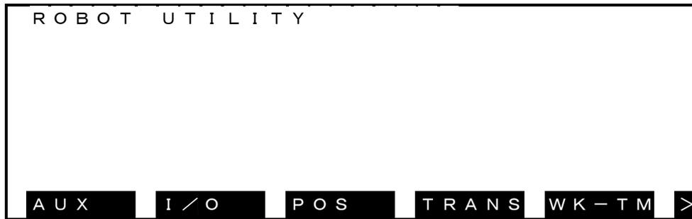
在实用程序模式可进行外部输入输出信号显示、现在位置显示、工件/工具坐标选择等操作。每按一次 NEXT，菜单就发生如下切换。
