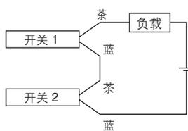
将2个开关AND连接的情况，ON时的负载电压下降，会引发负载的动作不良。另外，指示灯在2个开关都为ON状态时点亮。
