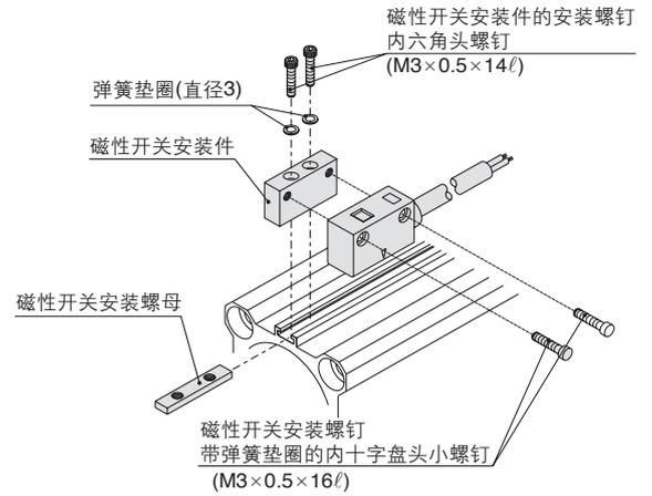
1. 用安装件的安装螺钉，从上面穿过安装件的通孔，将安装件预紧在开关安装螺母上。
